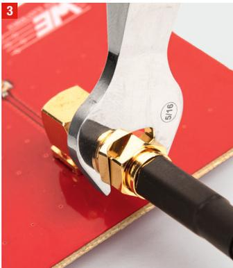
3 Schlüsselkopf auf die Steckerkupplung ausrichten.
